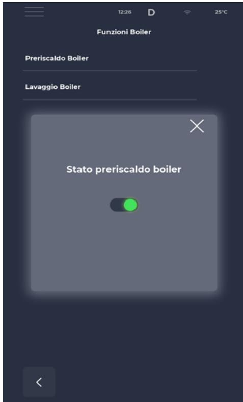
Il preriscaldamento del boiler/vaporiera può essere gestito con parametro P277 o manualmente sul menu "Funzioni Boiler".
